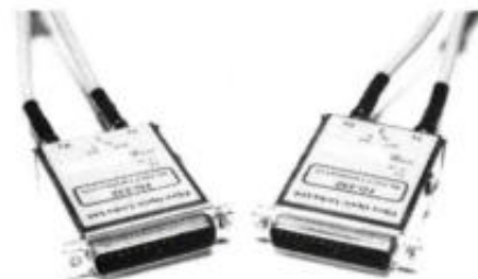
Afb. 7. Glasvezelmodem FO232 van Fibre Optic Links, ontwikkeld voor volledig-duplexoverdracht van asynchrone data via een glasvezelkabel over maximaal 2 km met een maximale bitfrequentie van 19,2 Kbit/s.
