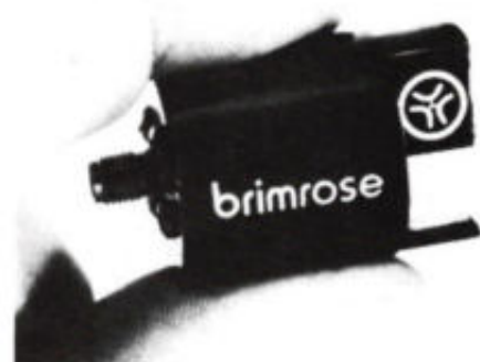
Afb. 2. Bragg-cel HIDI-90 van Brimrose Corporation (V.S.). Deze cel werkt op een frequentie van 1 GHz bij een bandbreedte van 350 MHz en heeft een optische apertuur van 0,7 \mu\text{s} bij 623,8 nm.
