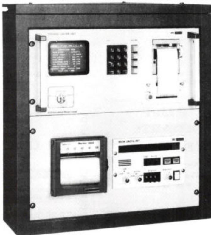
Afb. 7. Monitor- en besturingssysteem van het Oilcon-ballastmonitorsysteem voor olietankers.
